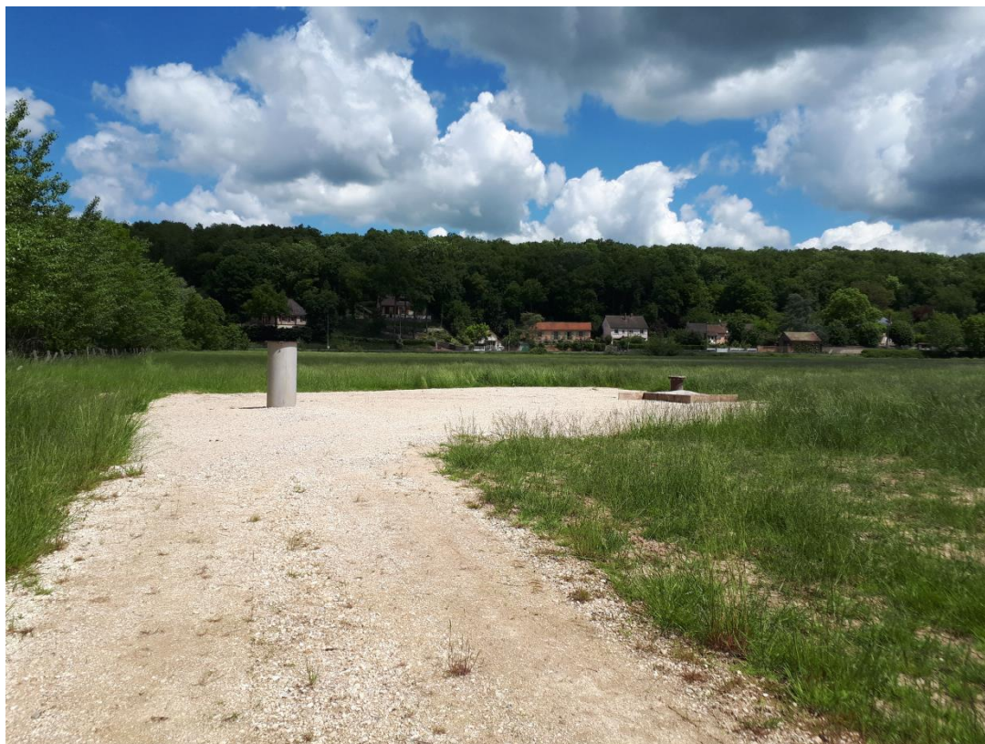
Vue sur la captage (à gauche) et sur le piézomètre à la craie (à droite)
